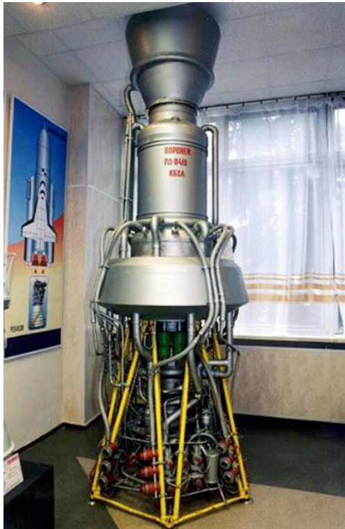
Рисунок 4. Первый в мире ядерный двигатель РД-0410
