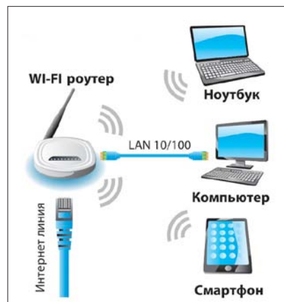
Рисунок 1. Как работает роутер
